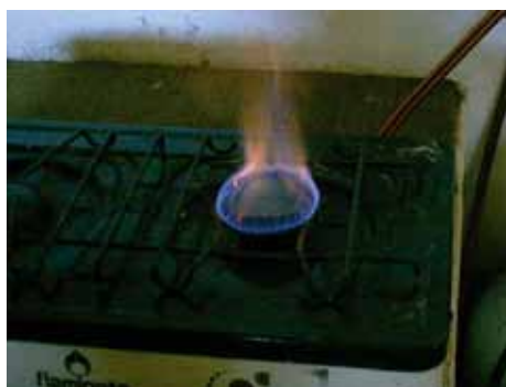
Quemadores con llama abastecidos por biogás
