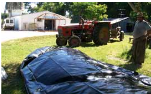
Inflado de biodigestor con escape de tractor. Predio del Sr. Guzmán González. Castillos. Rocha
