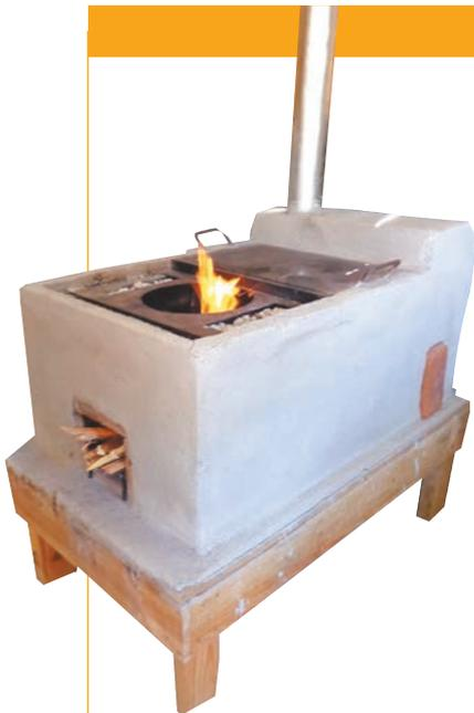
La cocina Joco-Justa está fabricada a base de ladrillos, lo que la hace fija y cuenta con una chimenea para expulsar el humo. Viene equipada con una plancha que puede ser usada para preparar tortillas y se puede retirar para cocinar más rápido en ollas de hasta unos 9-12 litros de capacidad. Gracias a su construcción es una cocina bastante duradera y resistente y reduce en gran medida el humo en la casa.
