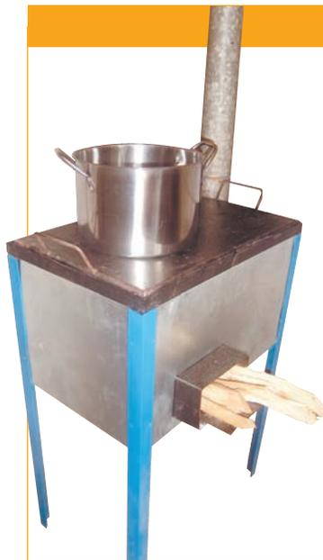
Ésta es una cocina con hornilla y plancha, que dispone de chimenea y está construida en metal, lo que permite garantizar al consumidor una durabilidad de hasta 4 años. Es apropiada para ollas de 10-12 litros de capacidad. Reduce bastante el consumo de leña y el humo. Muestra un mejor comportamiento en alimentos que requieren una cocción rápida como el arroz.
