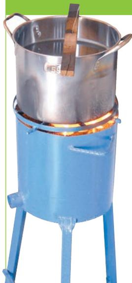
Es una cocina especial porque funciona con cascarilla de café, de arroz o aserrín. Una vez que se enciende no se puede apagar y la llama no se puede controlar así que no se puede usar para cocinar arroz. Es apropiada para ollas de hasta 12 litros de capacidad. Se debe usar en lugares ventilados porque emite bastantes gases durante su apagado. Es muy útil en invierno cuando la leña está mojada y la cascarilla de café está seca.
