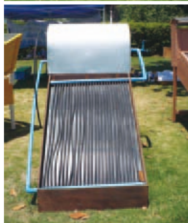
Arriba: secador de fruta. Abajo: colector solar destinado a calentar agua, para uso en una ducha o en la cocina.
