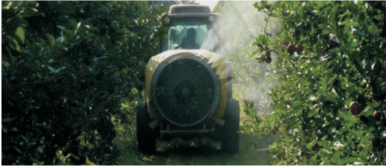
Figura 6: vista de la pulverización con picos antideriva (izquierda) y convencionales (derecha) (TOPPS Prowadis, 2014)
