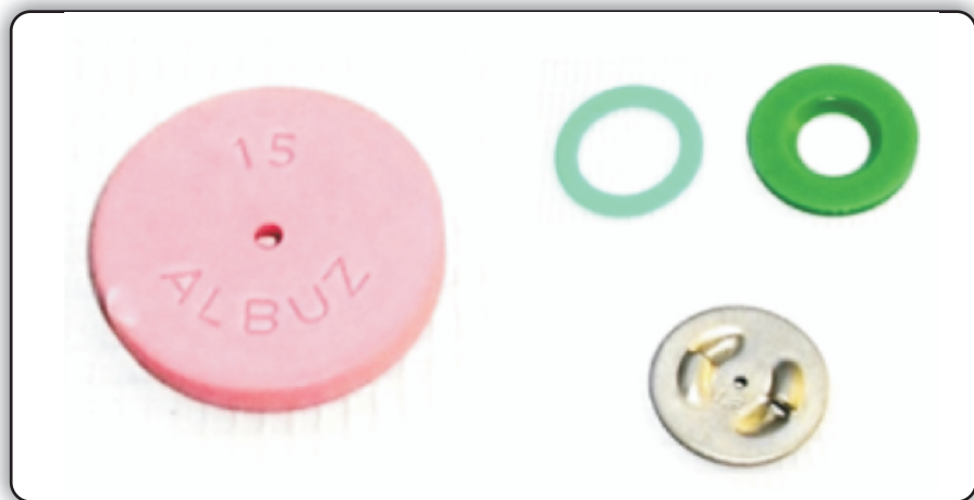
Figura 12: pastilla de cerámica de 1,5mm de orificio; junta de base; junta de empaque cónica; difusor de acero inoxidable "abierto" de 1,2 mm de orificio (Albuz, web).
