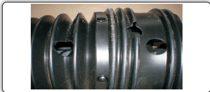
Figura 26: Aberturas para el engrase del cardán homocinético. (Foto gentileza Visca srl)
