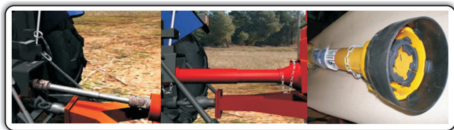
Figura 25: cardán sin protección (izq.); cardan con protección (centro); protector de cardán de repuesto (derecha. Foto gentileza Visca srl).
